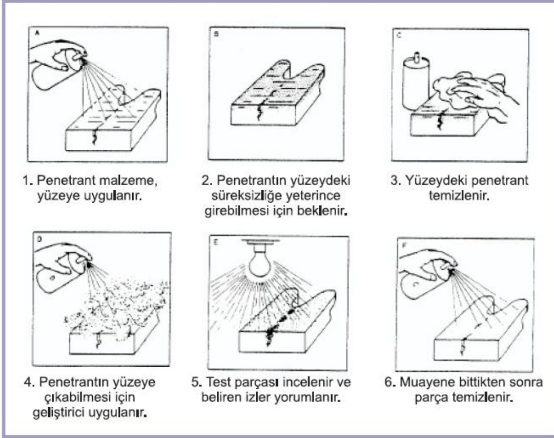
Şekil 3. Sıvı Penetrant ile Muayenenin Temel Aşamaları
